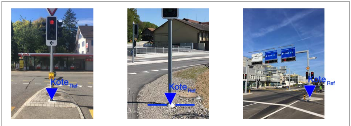
Abbildung 4: Beispiele Vermessung Normalmast und Signalbrücke
