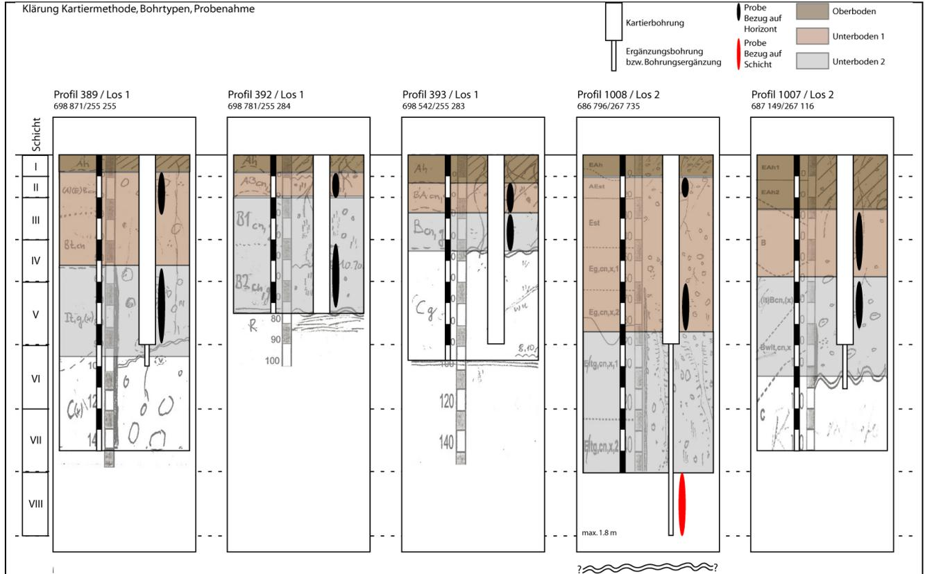
**Abbildung 4: Illustration von Bohr-Situationen und Probenentnahme**
